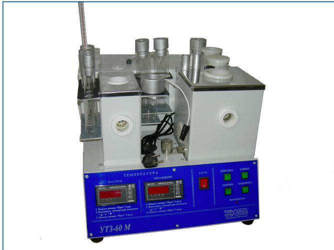
[Лабораторная установка УТЗ-60М](#) позволяет проводить испытания по определению: температуры текучести и прекращения текучести (застывания) нефтепродуктов температуры помутнения по [ГОСТ 20287](#) и [ГОСТ 5066-метод Б](#) (УТЗ-60М).
